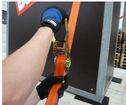
Abb. 5: Öffnen der Ratsche durch Ziehen des Fingerschiebers und Umschwenken des Handgriffs in 180° Stellung. Herausziehen des Gurtbandes
