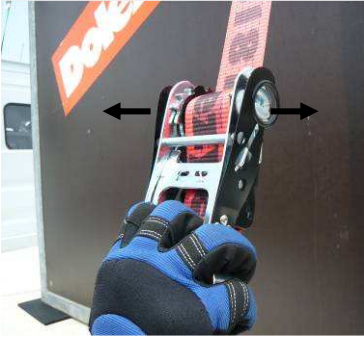
Abb. 6-7: Wenn der Fingerschieber bis zum Anschlag durchgezogen wird (über den ersten Widerstand hinaus), lässt sich der Handgriff nach vorne von dem Ratschenkörper abnehmen.
