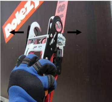
Abb. 8-9: Zum Anbringen des Handgriffs auf dem Ratschenkörper wird der Fingerschieber bis zum Anschlag durchgezogen (über den ersten Widerstand hinaus) und von vorne auf den Ratschenkörper gesetzt
