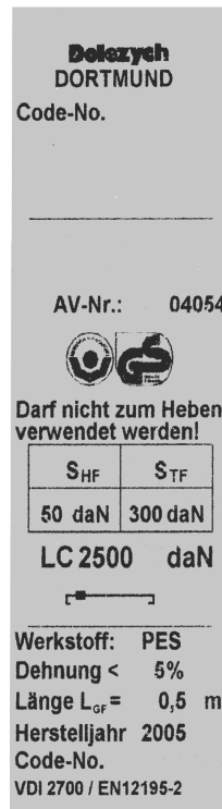
Abb.2: Bsp. eines Etiketts nach DIN EN 12195-2
