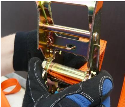
Abb. 2: Einführen des Gurtbandes
