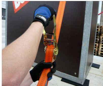
Abb. 5: Öffnen der Ratsche durch Ziehen des Spannschiebers und Umschwenken des Handgriffs in 180° Stellung. Herausziehen des Gurtbandes.
