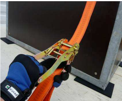
Abb. 4: Spannen durch Auf- und Abwärtsbewegungen des Handgriffs, bis die gewünschte Vorspannkraft erreicht ist. Ratsche nach dem Spannen unter Ziehen des Spannschiebers vollständig schließen.
