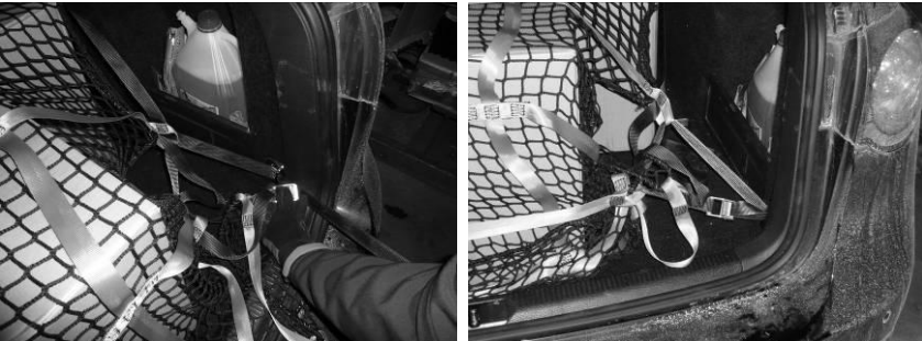
Abb. 8-9: Anschließend das Gurtband durch den Zurrpunkt und die Gurtklemme ziehen und verspannen.
