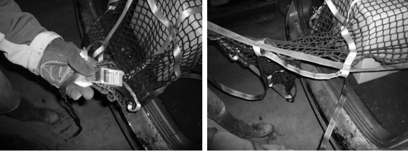
Abb. 6-7: Wenn nötig (wie in unserem Bsp.) das Zurrnetz auf die gewünschte Länge einkürzen. Dazu die Losenden der Schnellspanner durch die seitlichen Schlaufen ziehen.
