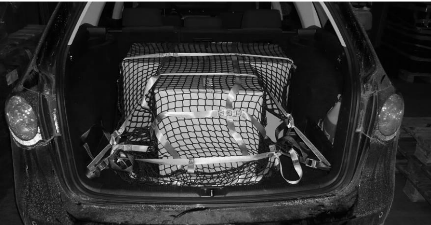
Abb. 10: Die Ladung ist normkonform gesichert.
