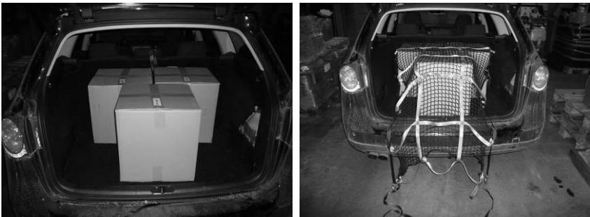
Abb. 4-5: Die Ladung in den Kofferraum stellen und das Zurrnetz über die Ladung ziehen
