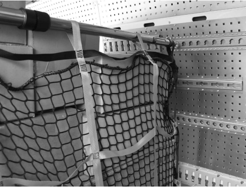
Abb. 18: Einsatz als Laderaumtrennung.
