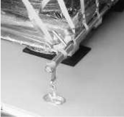
Abb. 15: Verankerung der DoVario-Teleskopstange in den Zurrösen.
