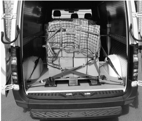
Abb. 17: Verspannung des Netzes mittels Schnellspannern.
