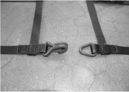
Abb. 22-23: Verlängerung des DoKEP-Hauptnetzes mittels DoKEP-Erweiterungsnetz
