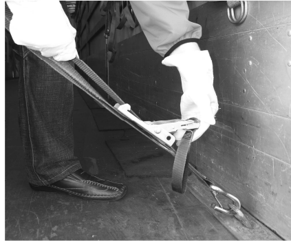
Abb. 19: Spansschloss nach oben umlegen
