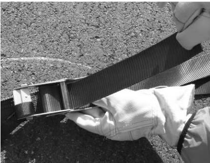
Abb. 16-17: Schnellspanner für den Einsatz vorbereiten
