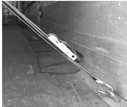
Abb. 21: Spansschloss im geschlossenen (gesicherten) Zustand
