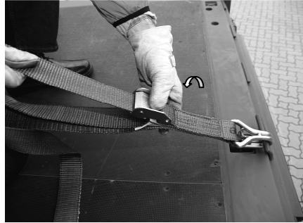
Abb. 9: Zum Lösen Hebel betätigen
