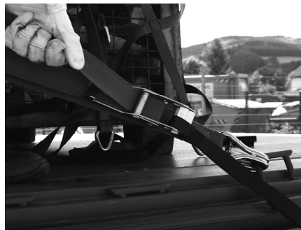
Abb. 25-27: Anwendung DoKEP-Sperrstange und Schnellspanner
