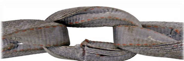
Abb. 4: Einschnitt im Kettenglied
