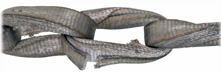
Abb. 2: Durchtrennte Gurtbandlage außen.
