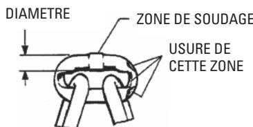
CHAINE SI ELLE NE REPOND PAS A TOUS LES POINTS DE CONTROLE. GRAISSER LA CHAINE APRES EMPLOI. SI LA CHAINE N'EST PAS PROPRE ET PAS GRAISSEE CELA PEUT PROVOQUER UNE USURE PREMATUREE.
