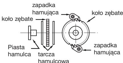
Przy montażu systemu hamulcowego należy się upewnić, czy koło zębate, pista hamulca oraz tarcze hamulcowe są wolne od oleju i tłuszcza oraz czy zapadka hamująca jest całkowicie zaczepiona w kole blokującym.
