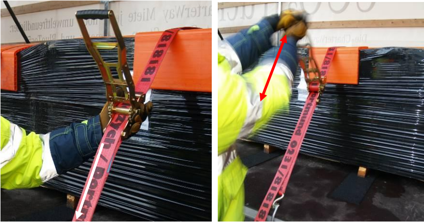
Abb. 5-6: Gurtband mit der Hand fixieren und solange ratschen, bis die gewünschte Vorspannung ( S_{TF} ) erreicht ist. Es müssen min. 1,5 / max. 3 Umwicklungen auf der Spannwellen der Ratsche vorhanden sein. Nach dem Spannen muss der Ratschengriff geschlossen werden.
