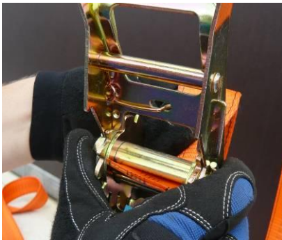
Abb. 2: Einführen des Gurtbandes
