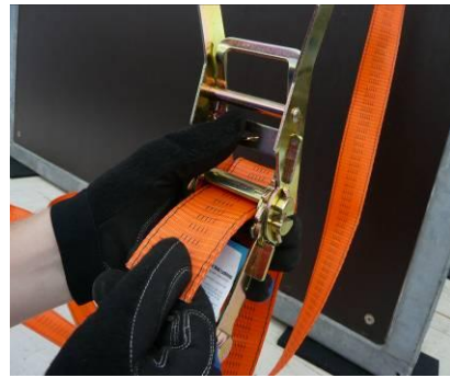
Abb. 3: Per Hand auf die gewünschte Länge festziehen.
